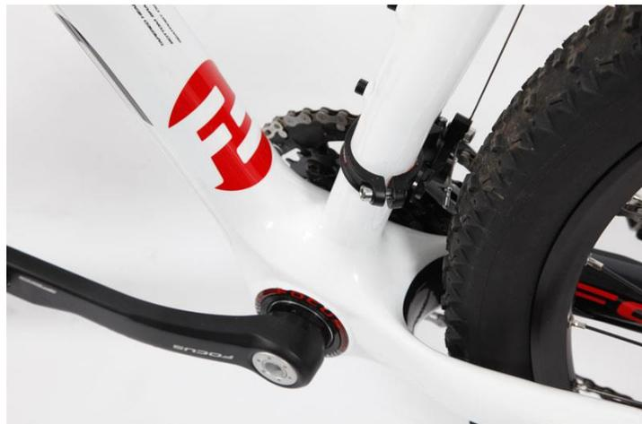
Una buena limpieza y engrasado del eje de pedalier eliminará las fricciones entre piezas, haciendo desaparecer los ruidos.
