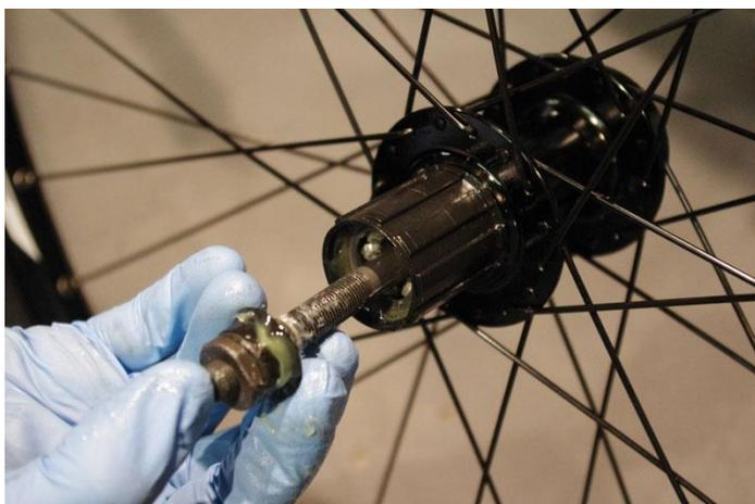
**Desinstalación de la Tuerca Cónica del Núcleo.**
