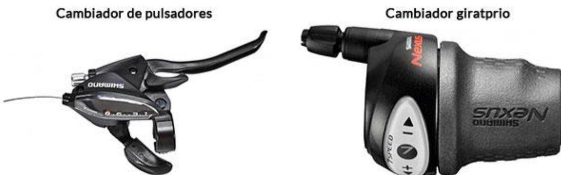
Van colocadas en el manillar y cuentan con un mecanismo que activa un cable que hace que los desviadores muevan la cadena entre platos y piñones. Existen palancas de cambio de fricción (pura y retro-ficción) y cambios de indexación que es el más frecuente hoy en día.
