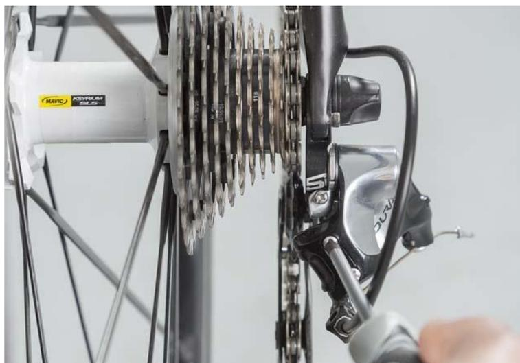
Ubica el destornillador sobre el H y aprieta hasta que alcances una alineación de la roldana superior con la corona
