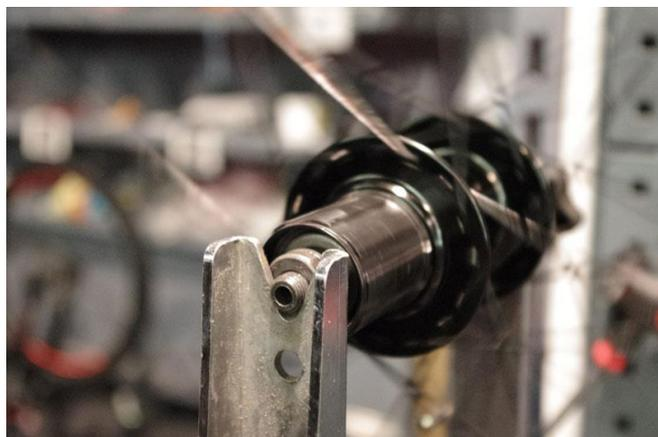
Deja un poco suelta la tuerca cónica del núcleo, para facilitar el ajuste de la tuerca exterior.
