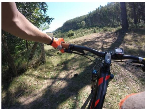
Mando Único Para Horquilla y Amortiguador, con dos Posiciones, Bloqueo (Bicicleta Rígida) y Desbloqueo (Suspensión Activa)
