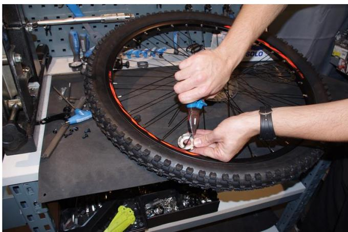
**Retirada del Radio Estropeado**
